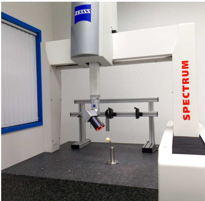
Videoptischer Sensor ViSCAN Multisensorisches Koordinatenmessgerät SPECTRUM von Carl Zeiss Oberkochen
