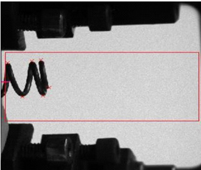
Schwingende Feder in der Maschine mit automatischer Nachführung der Messpunkte
